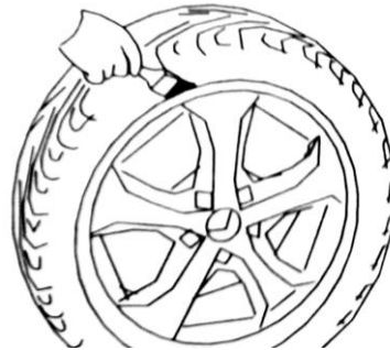
Рисунок 4.2 – Нанесение смазки на борт шины
